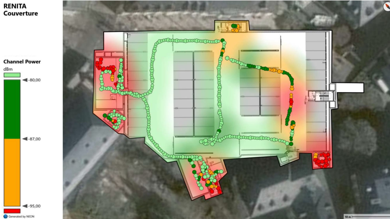
Exemple de mesurage de couverture
